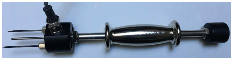
Figure 10 - Exemple d'humidimètre à pointe
