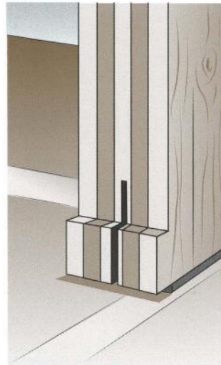
Exemple de liaisons spécifiques par plaques métalliques cachées
