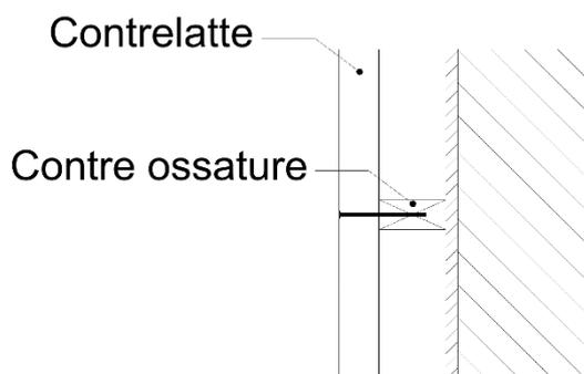
Figure 10 - Fixation de la contrelatte à son support horizontal, avec isolation complémentaire
