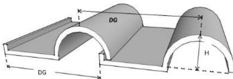
Figure 17 - Détermination du galbe de tuile
