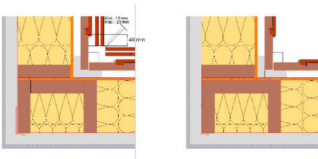
Figure 29 - Coupe horizontale sur angle rentrant
