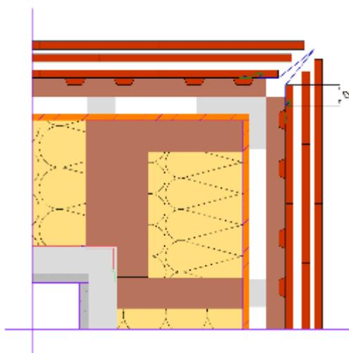
Figure 31 – Exemple de profilé n°1 angle sortant
