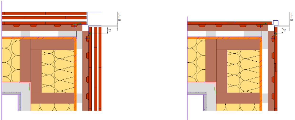
Figure 32 – Autre exemple de profilé d'angle sortant
