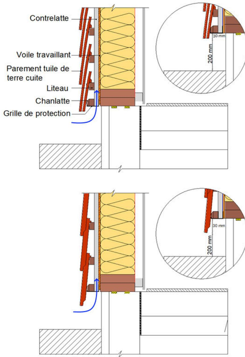
Figure 35 - Détail du pied de mur
