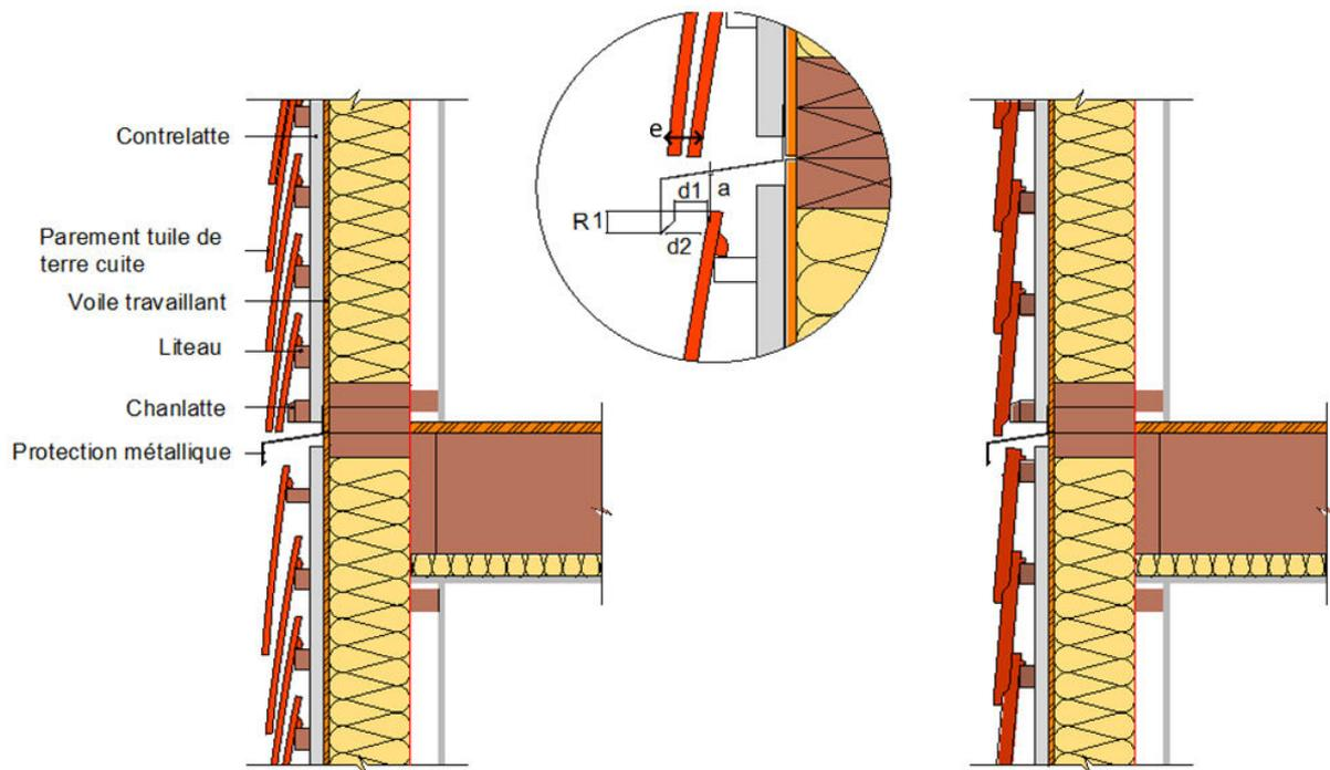
Figure 39 - Détail jonction entre niveaux
