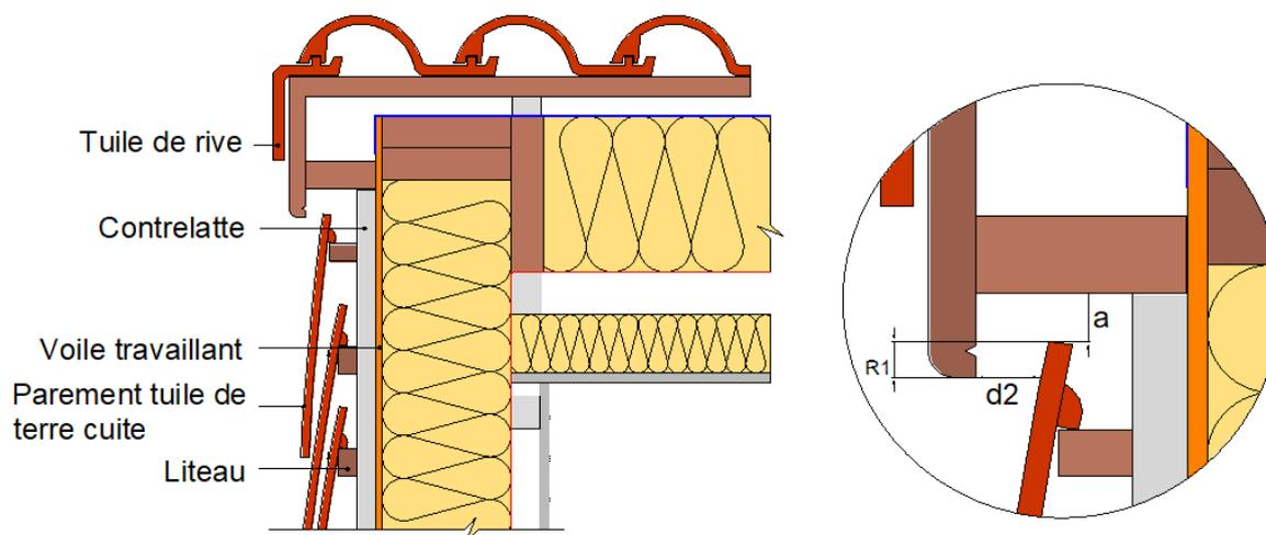
Figure 37 - Détail jonction toiture au niveau du pignon
