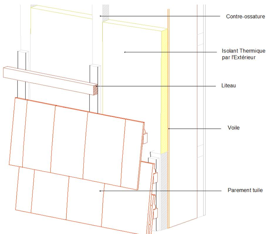
Figure 7 : Exemple d'ossature secondaire à trois réseaux (avec contre-ossature verticale)
