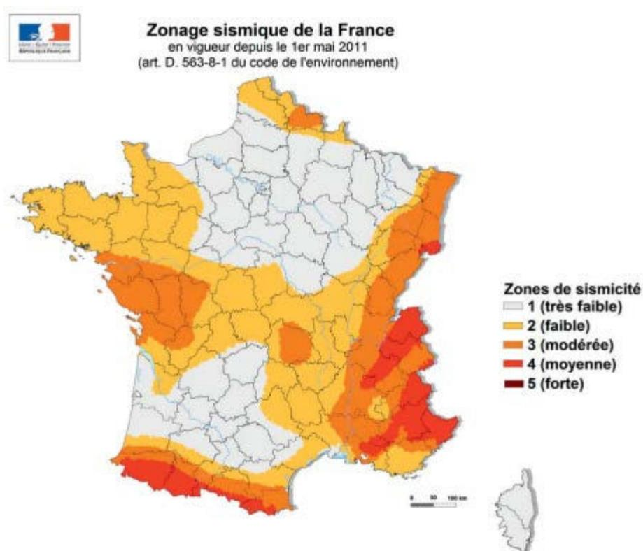
Figure 42 - Zonage sismique de la France Métropolitaine
