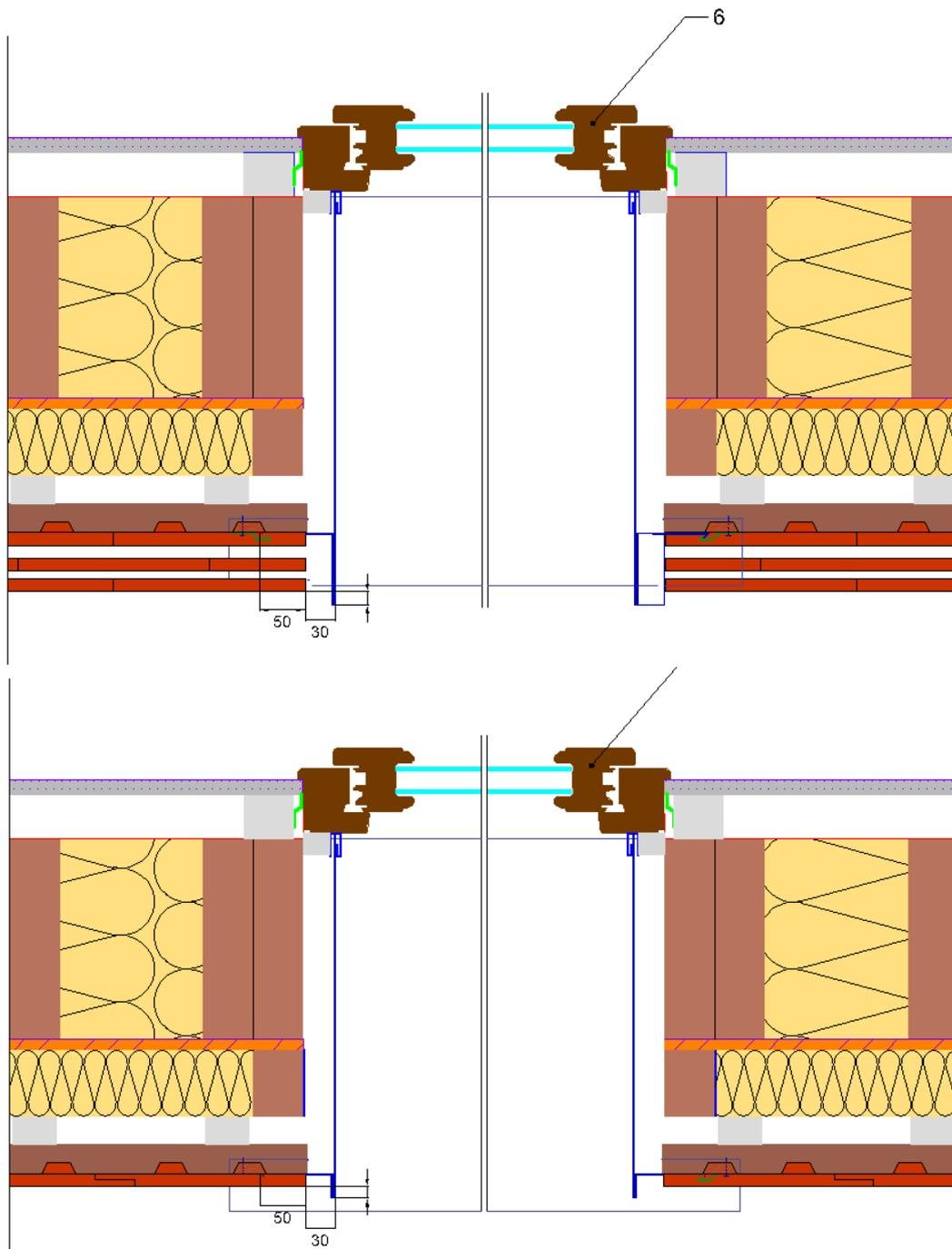
Figure 27 - Coup horizontale sur menuiserie en applique intérieure avec pré-cadre bois et ITE
